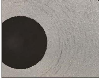
6° yaklaşma açısı – Rz 11.3 µm
